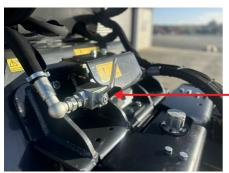
Isolater Switch (To isolate saw)
