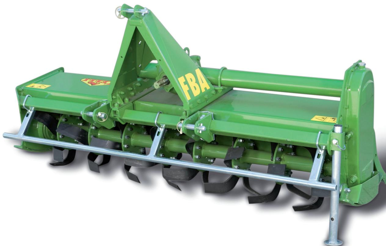
La fresatrice F/BA combina un design semplice e moderno a caratteristiche tecniche normalmente riservate a modelli di categoria superiore. Il telaio è costituito da una doppia lamiera scatolata per garantire una adeguata rigidità; gli organi di trasmissione sono sovradimensionati; lo scudo mobile posteriore è ben sagomato in modo da garantire un efficace livellamento del terreno dopo la lavorazione.
