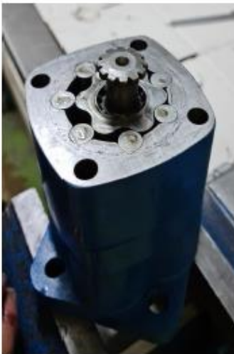
7.- Remove the drive link.
