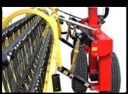
PARALLEL LINKAGE TORSION BASKET SUSPENSION
